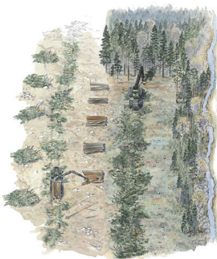
Figur 12. Illustrationen visar ett körsätt som bör tillämpas vid avverkning nära vatten. Genom att både skördare och skotare nyttjar hela kranens räckvidd kan skotaren gå långt från den lämnade kantzonen. I det här exemplet kan skotaren gå på fastmark. Därigenom förhindras uppkomsten av körskador. Illustration: Martin Holmer.
